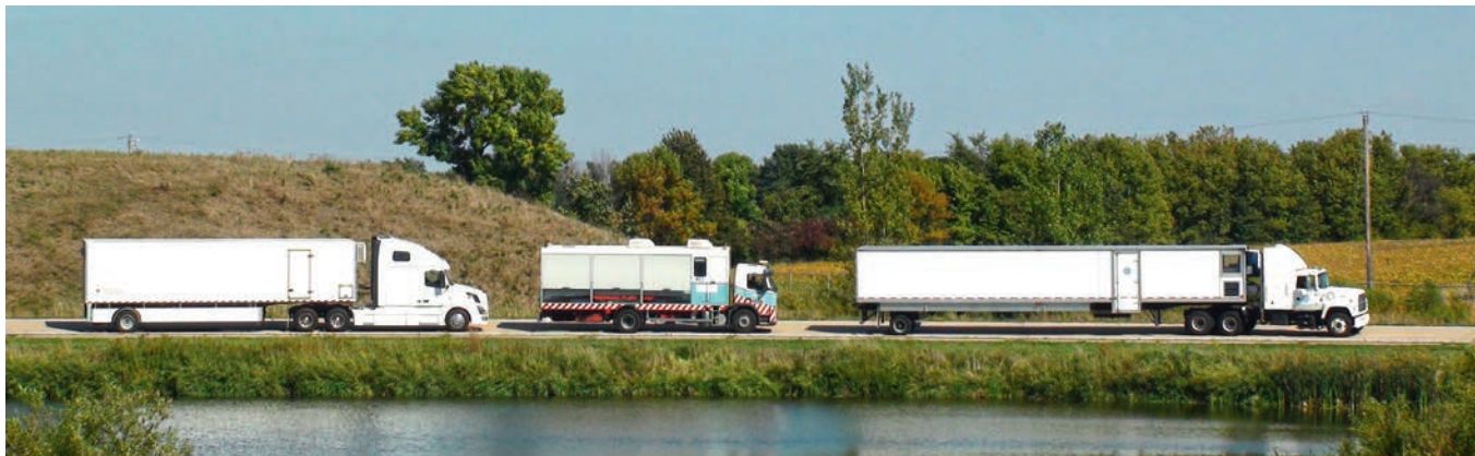
–Photo 2– Matériels de mesure de déflexion. De gauche à droite : Traffic Speed Deflectometer (TSD), curviamètre, et Rolling Wheel Deflectometer (RWD).
