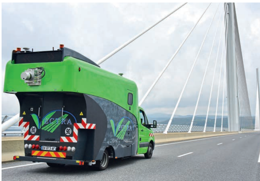
-Photo 1- Nouveaux capteurs pour nouvelles méthodes d'auscultation : le SYMAN de Vectra.
